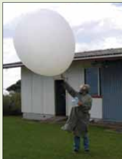
Figure B2.2. Lâcher d'un ballon rempli d'hydrogène auquel est fixé une radiosonde – Île de Lord Howe.
