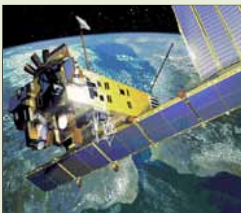
Figure B2.4. ENVISAT, un satellite européen fournissant des observations continues sur la Terre, y compris des mesures liées aux propriétés chimiques de l'atmosphère, à la température de surface de la mer et à la couverture de glace.
