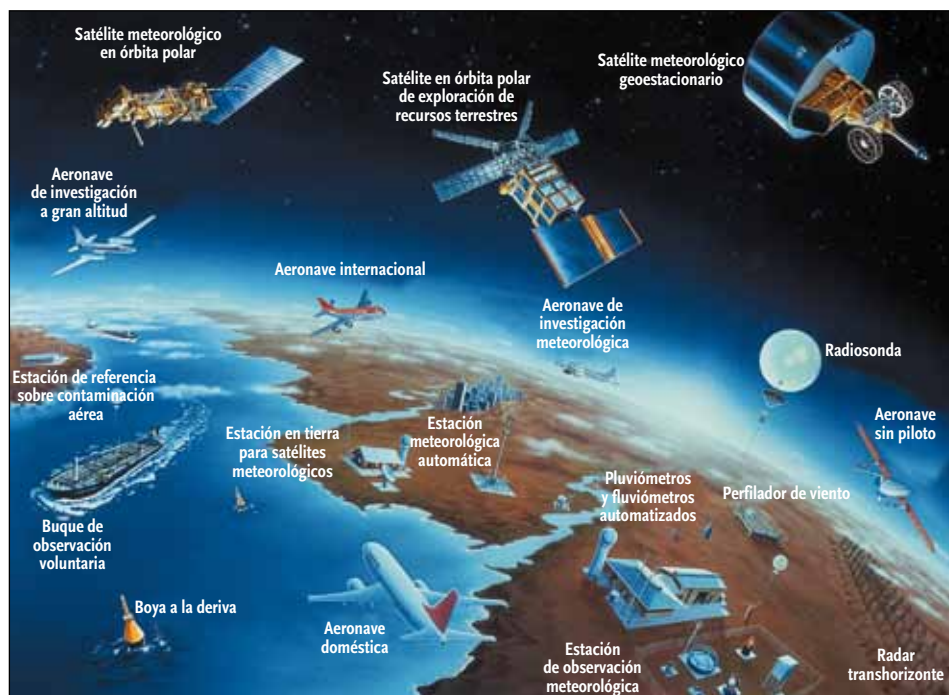
Figura 2.1. Ilustración de los múltiples sistemas de observación utilizados en tierra, en el mar, en la atmósfera y desde el espacio para la vigilancia e investigación del sistema climático
