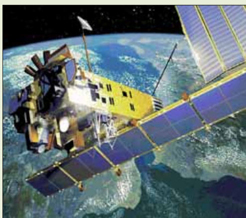
Figura R2.4. ENVISAT, un satélite europeo que facilita observaciones de la Tierra de forma continua, en particular mediciones relacionadas con la química atmosférica, la temperatura de la superficie del agua y la capa de hielo
