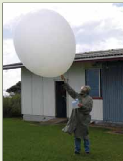
Figura R2.2. Liberación de un globo relleno de hidrógeno y provisto de una radiosonda en la isla Lord Howe
