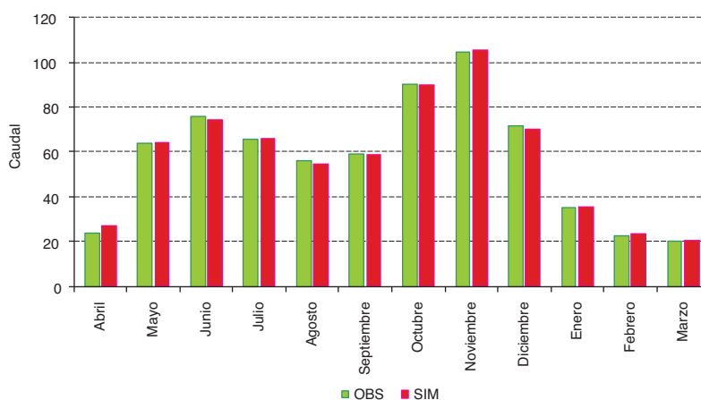
GRÁFICO A5.4 COMPARACIÓN DE VARIACIÓN ESTACIONAL DEL PERÍODO DE CALIBRACIÓN CON LOS CAUDALES OBSERVADOS DEL AFLUENTE A LA LAGUNA LAJA, 1966-1994 (En metros cúbicos por segundo)
