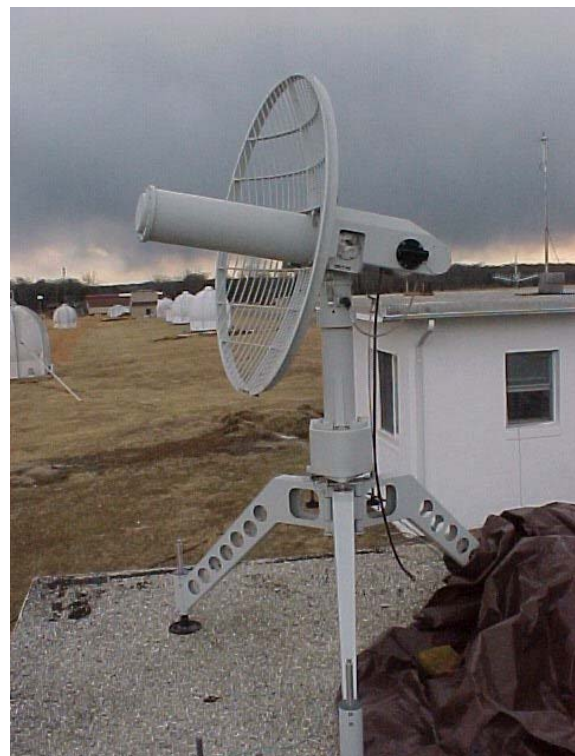
FIGURA 3-7 Sistemas de antenas de seguimiento (1 668,4-1 700 MHz)
