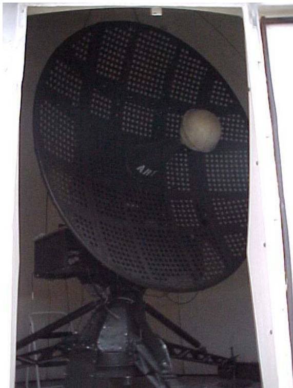
FIGURA 3-7 Sistemas de antenas de seguimiento (1 668,4-1 700 MHz)
