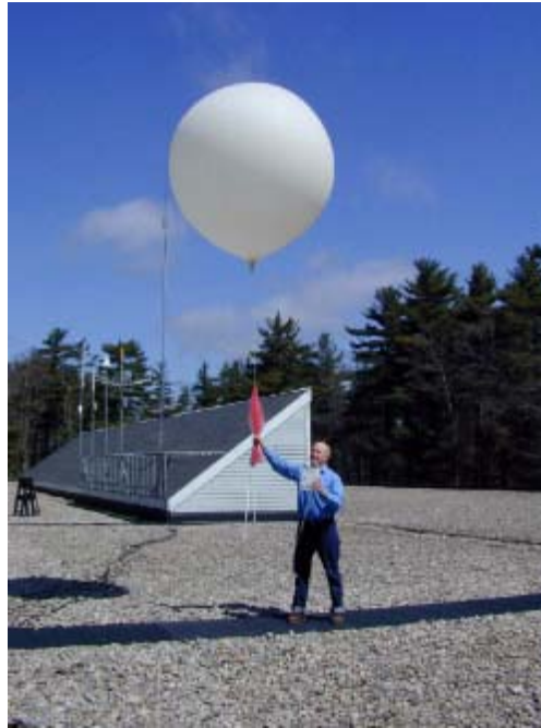
FIGURA 3-1 Tren de vuelo de una radiosonda
