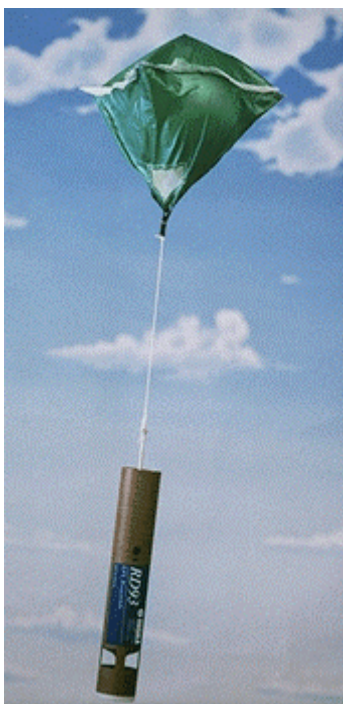
FIGURA 3-4 Radiosonda con paracaídas
