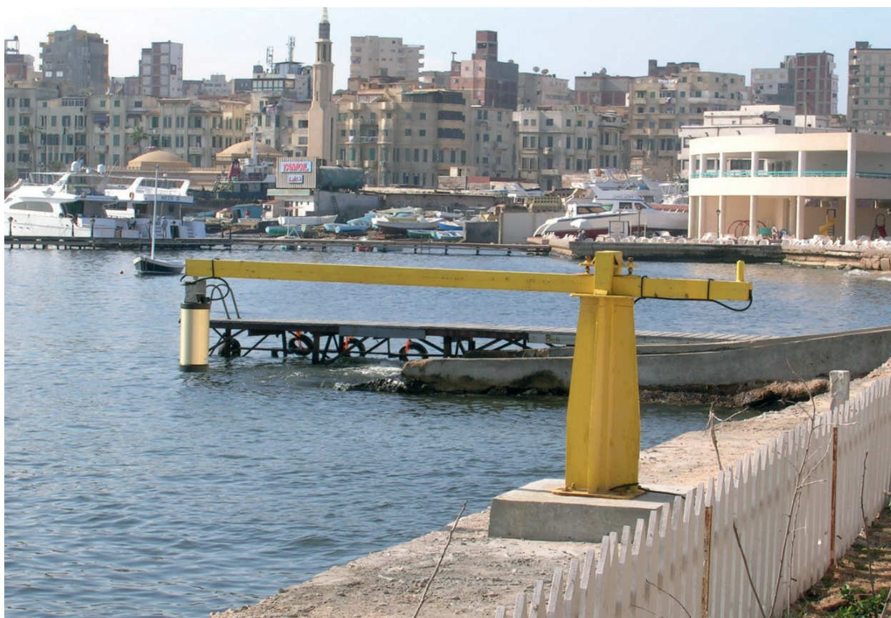
Figure 4.3 Un marégraphe OTT Kalesto à Alexandrie à l'extrémité d'un bras coulissant qui est fixé par des boulons. (Photo T. Aarup, COI).
