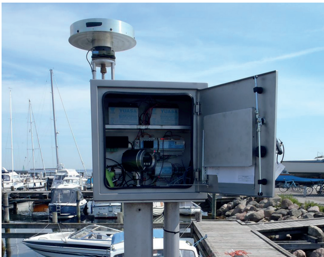
Figure 4.6 Une installation à Dragør, Danemark. À gauche on peut voir un marégraphe radar Endress+Hauser monté au sommet d'un tube en acier inoxydable (environ 17 cm de diamètre) qui sert de puits de tranquillisation et de guide d'ondes. Ce tube est muni à son extrémité d'un trou d'admission de 30 mm de diamètre. À l'intérieur du tube se trouve un filtre destiné à empêcher les intrusions biologiques. Le sommet du tube comporte 4 trous munis de filtres destinés à empêcher la condensation sur l'antenne du radar. À droite on peut voir un tube en acier inoxydable contenant les câbles du capteur de pression. (Photo de l'Institut Danois de Météorologie).
