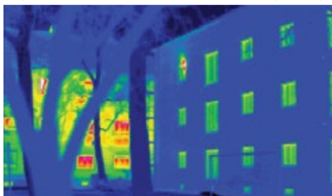
Рис. 3.2.13. Фотография в инфракрасных лучах показывает, насколько эффективнее теплоизоляция пассивного дома (справа) по сравнению с обычным домом (слева).
